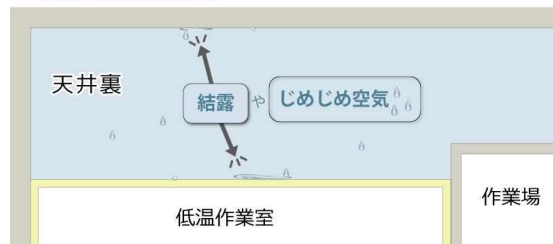
ドライチェンジャー 設置後 天井裏の空間が除湿され、結露を解消
