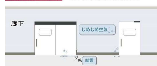
ドライチェンジャー 設置前 低温室との温度差により 結露が発生
