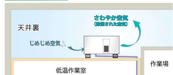
ドライチェンジャー 設置後 天井裏の空間が除湿され、結露を解消
